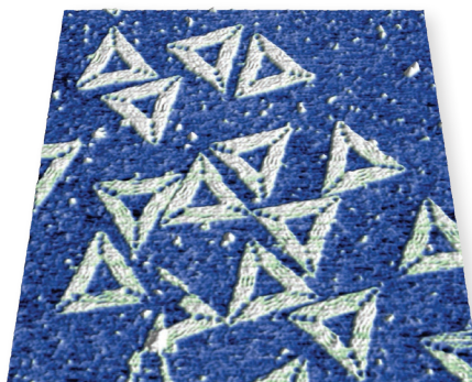
DNA折纸三角: 液体成像, 每个边长约120 nm, 600 nm扫描。感谢加州理工学院的P.W.K. Rothmund提供样品。
