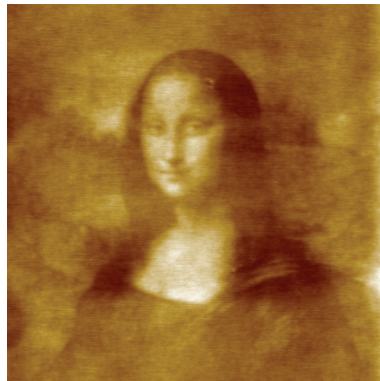
通过刮擦聚碳酸酯形成的纳米刻蚀图 20 µm扫描
